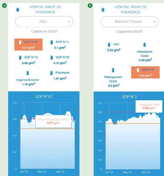
Suivi en temps réel de l'empoussièrement des réseaux de soufflage qui asservissent des salles d'opération (SOP n° 7 et SOP n° 2) de l'hôpital privé de Provence.
