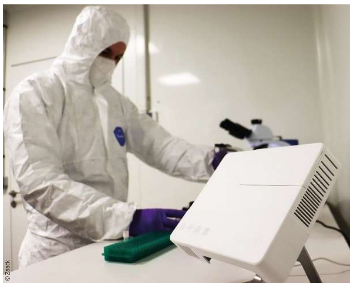
Mise en place de capteurs de mesure spécifiques à la surveillance du comptage particulaire en temps réel dans une salle classée.
